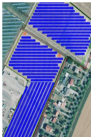
Bild 1b: Ausschnitt aus dem Modullayout mit Darstellung der Teilfläche Süd in Satteldach-Anordnung bzw. Orientierung aller Modultischreihen unter dem Winkel \nu = 117^\circ
