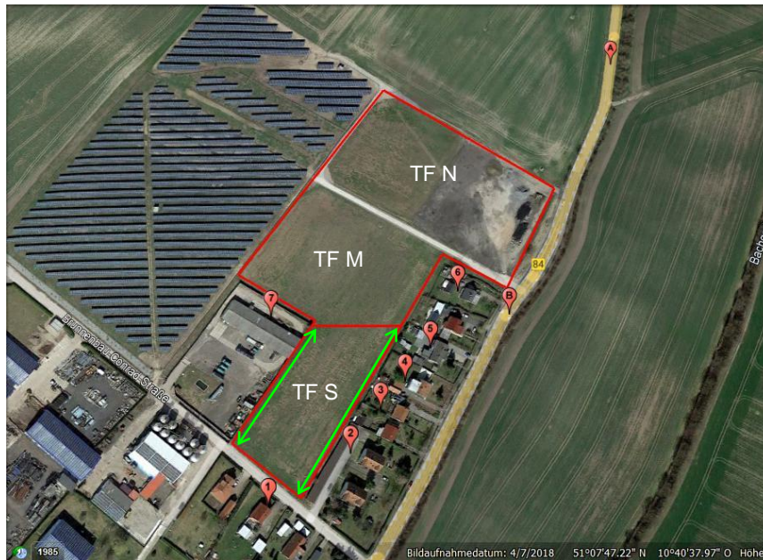
Bild 1a: Übersicht der geplanten PV-Anlage Merxleben mit den Teilflächen TF N, TF M und TF S sowie den untersuchten Blickpunkten A und B auf der B 84 und den Immissionsorten 1 bis 7
