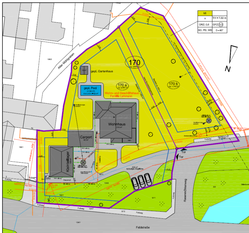
Abbildung 1: Lageplan Baustandort EFH Lehmann Bad Langensalza; Quelle: Planungsbüro Kellner: Standortbezogener B-Plan vom 11.03.2022
