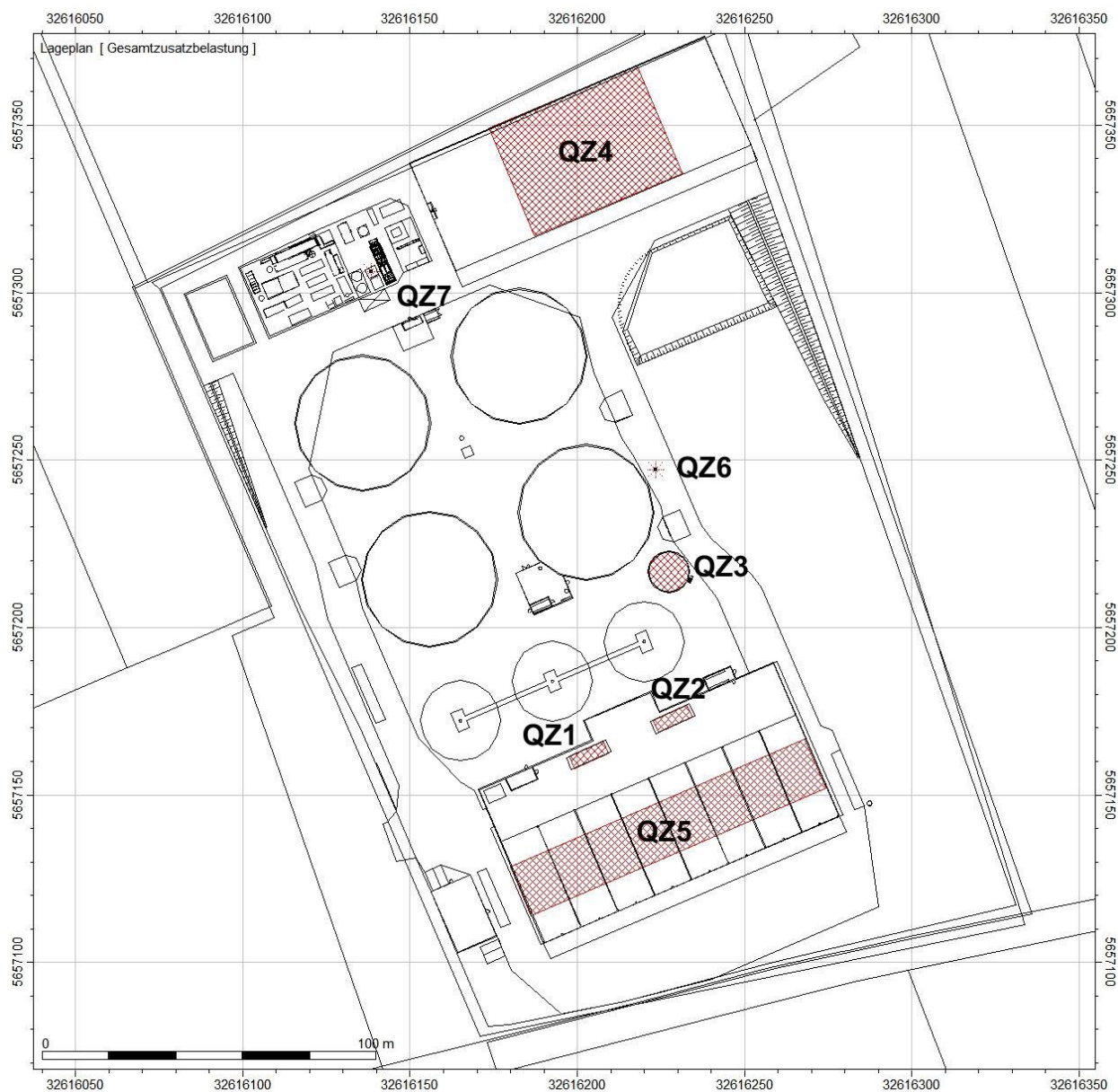
Abbildung 13: Emissionsquellenplan des Sondergebietes SO „Biogasanlage“
